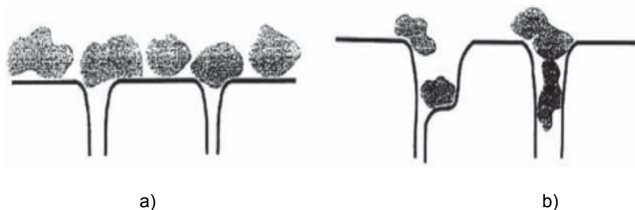
Figura 8 – Colmatação da membrana: (a) colmatação externa (b) colmatação interna (Kanani 2015)
